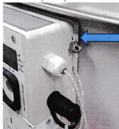
Монтаж термопреобразователя сопротивления Pt500 (500П) на корпусе счетчика
